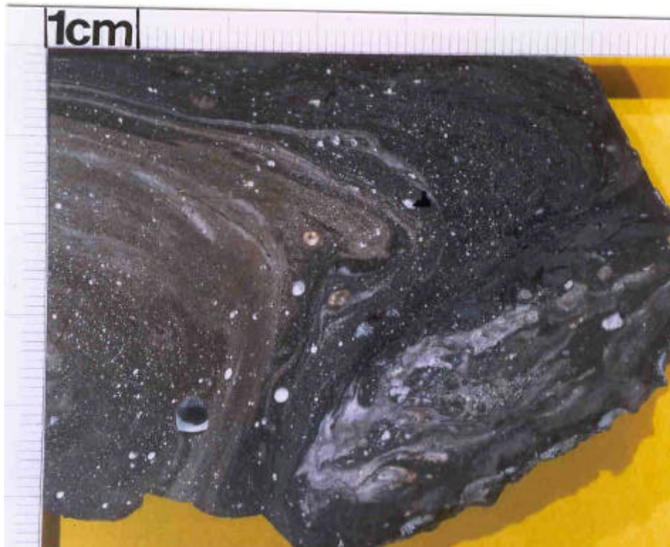
Abb. 9: Friktionit (Hyalomylonit) der primären Gleitfläche von Langthang (geschnitten und geschliffen) zeigt neben dunkel bis beige gefärbtem, schlierigem Gesteinsglas, heller Mikrobrekzie und granitischen Gesteinsfragmenten zahlreiche kleinere Hohlräume von Entgasungsblasen (Foto: J.T. Weidinger, 1991).
