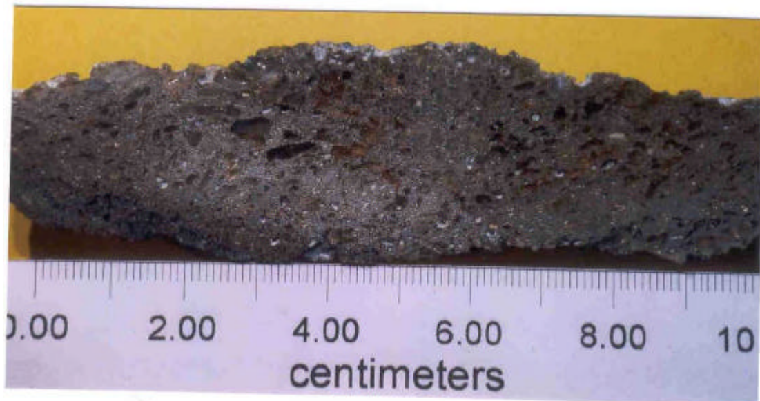
Abb. 10: Friktionit (Hyalomylonit) in Form einer stark porösen Bimssteinknolle (geschnitten und geschliffen), von einer sekundären Gleitfläche entnommen (Foto: J.T. Weidinger, 1991).
